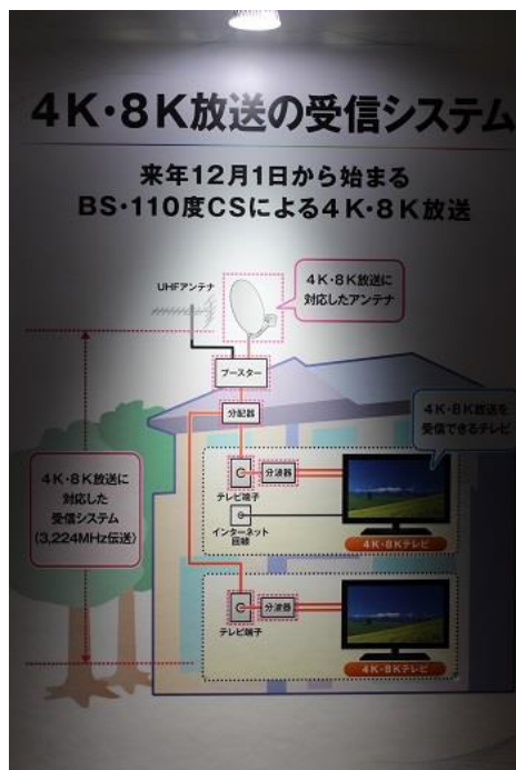
図5. 4K・8K放送の受信システム（スーパーハイビジョンパークでの展示より）
