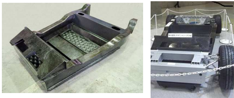
図2 試作したシャシー部品（左）と組み立て品（右） 出展；NEDO（左）、18年1月の展示会NEDOブース（右）
