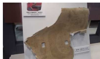
図3 ケナフ繊維を使用したPPとの複合材料 (2018年5月 @パシフィコ横浜)
