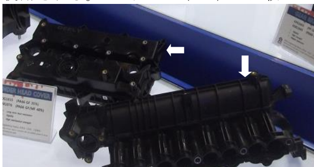
図1 PA66+GFのエンジンカバーの例 (2018年4月CHINAPLAS@上海)
