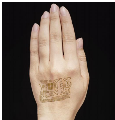
図.1 ナノメッシュ電極の構造と装着方法 図.2 皮膚張り付け型メッシュ型電極
