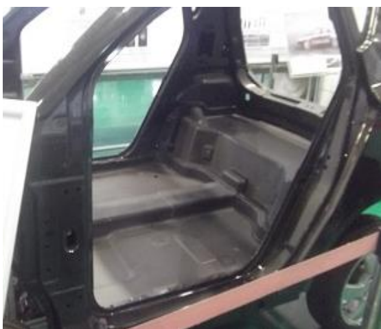
図2 金属とCFRPを接合（矢印部）した車体（出典：中国、寧波にて筆者撮影）
