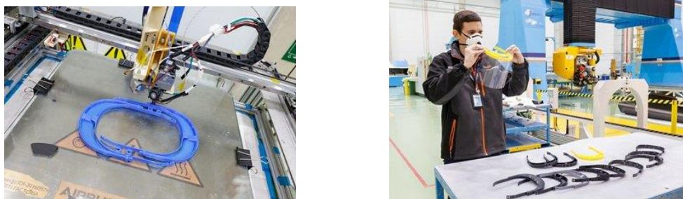
図1 エアバスの3Dプリンタでのフレーム生産と製品 出典；エアバス
