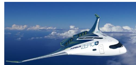
図.2 水素燃料電池利用「Blended Wing Body」モデル 出所) Airbus社プレスリリース
