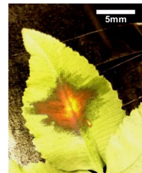
ナノバイオティクス処理されたシダの葉をスマホで撮影。土壤中のヒ素が濃縮された部位が着色されている。（Lew et al. Adv. Mater.より引用）
