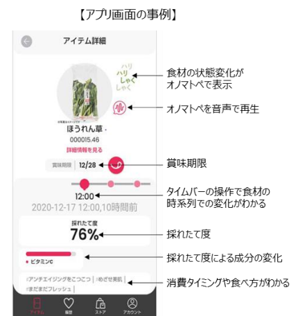
【アプリ画面の事例】 (出所) IoT技術を活用したスーパーマーケットにおける食品ロス削減事業実証実験概要 2021年1月 経済産業省
