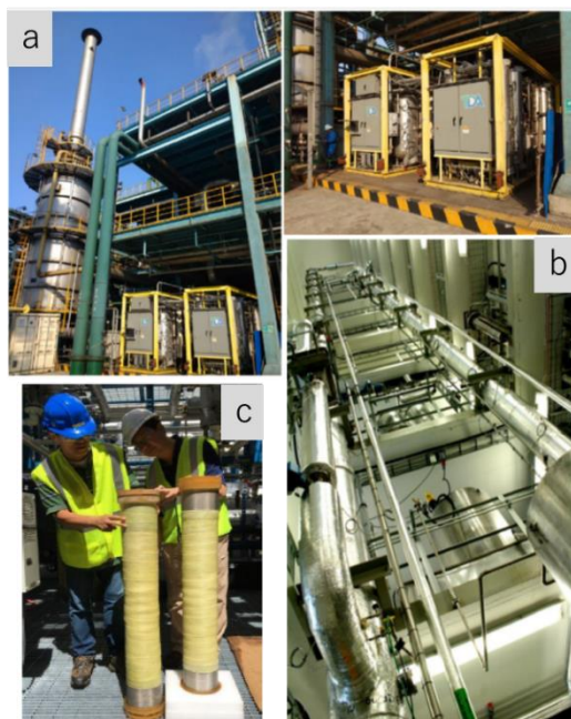
a) TDAによるSinopec工場でのパイロット実証 b) RTIによる非水溶媒系吸収材のパイロット実証 c) GTIが試作した酸化グラフェン膜モジュール
