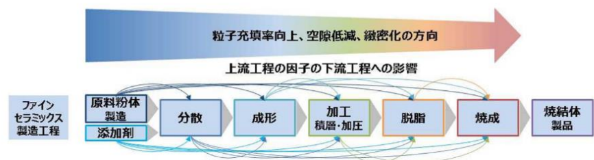
図.1 ファインセラミックス製造での工程間の影響イメージ
