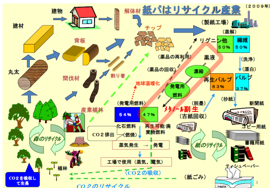
図1. 製紙（パルプ製造）の流れ 出所：環境省webより、一部ARC追記
