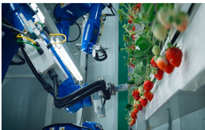
24 時間イチゴの成長を見守り自動収穫するロボット
