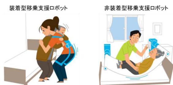
図 4 移乗介助支援ロボット（厚生労働省資料より引用）
