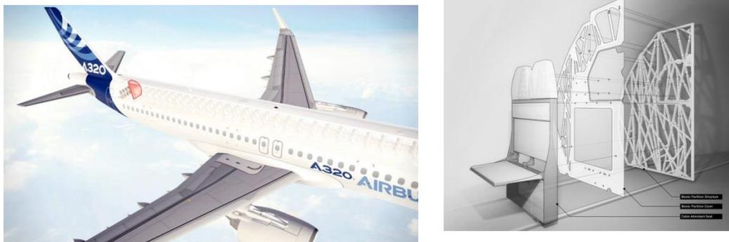
図 7 パーティションの位置（左）と積層造形で製造された構造（右）
