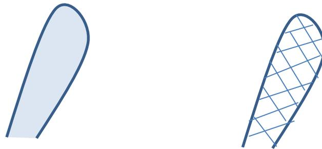
図 11 一体型成形品（左）と内部がラティス構造になった成形品（右）のイメージ
