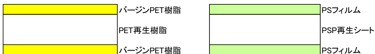
図 9 エコ APET シートとエコ PSP の 3 層構造 (イメージ)
