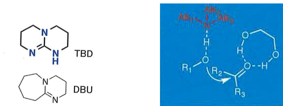
第一世代 TBD 触媒と第二世代 DBU 触媒 第三世代トリアルキルアミン触媒の配位
