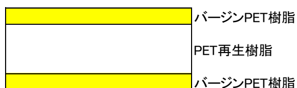
図 10 エフピコ APET シートの 3 層構造(イメージ)
