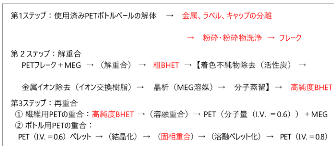
図2 アイエス法のPETボトルの解重合と再重合
