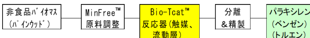
図 9 Anellotech のパインウッドからのバイオパラキシレンの製造ルート
