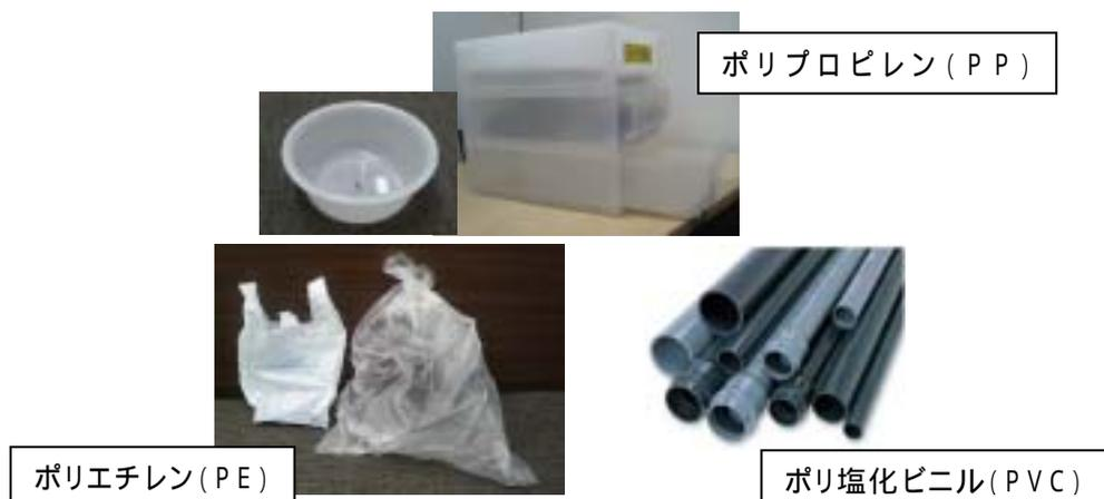
図6 汎用プラスチック（PE、PP、PVC）の成形品例
