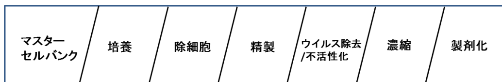
図4 バイオシミラーの製造フロー（出所：資料 16 を参考にARC作成）
